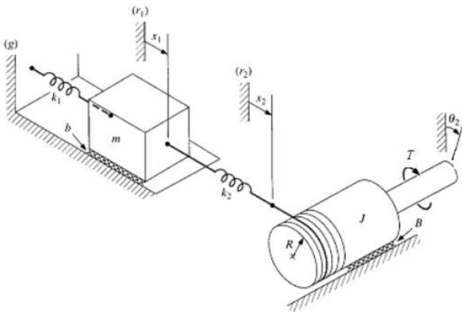
Şekil öteleme ve dönme elemanlarına sahip mekanik bir sistemini göstermektedir.
